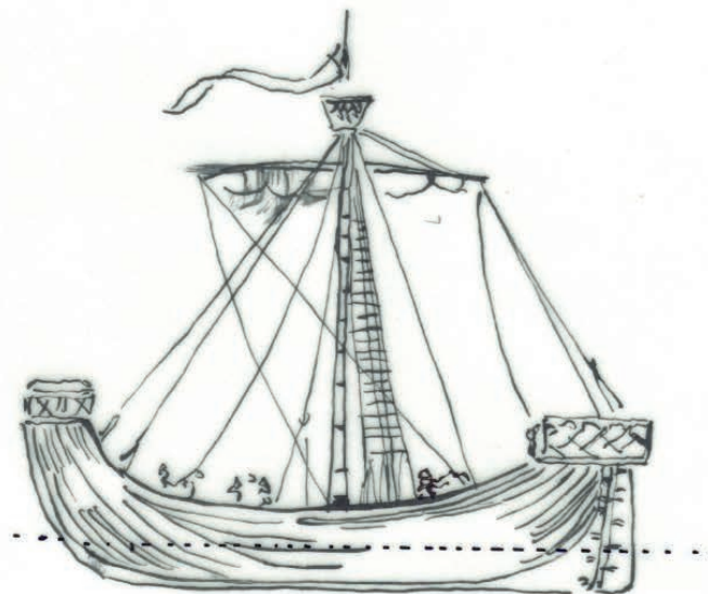
VOILIER DU XV e SIÈCLE. Navire avec un gouvernail d'étambot: beaucoup plus maniable
